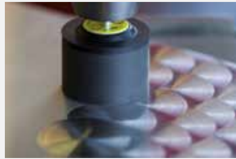
Приклад декоративного шліфування за допомогою головки для обробки „під мрамур“ R-Flex SFM 656 на нержавіючій сталі
